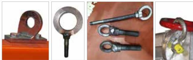
произвести контроль в случае возникновения ущерба и особых происшествий. Целью осмотра является выявление их состояния по признакам браковки. Осмотр должен производиться в соответствии с требованиями инструкции по эксплуатации, определяющей порядок и методы осмотра, браковочные показатели. Поврежденные такелажные точки должны изыматься из работы. Основными критериями предельных состояний являются:
