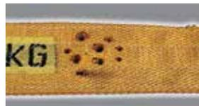
Повреждение в результате воздействия высокой температуры
