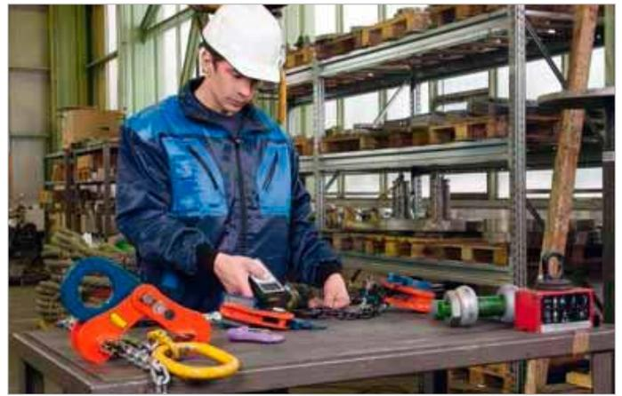
Проверка на наличие микротрещин методом магнитно-порошковой дефектоскопии
