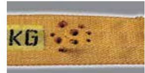
Повреждение в результате воздействия высокой температуры
